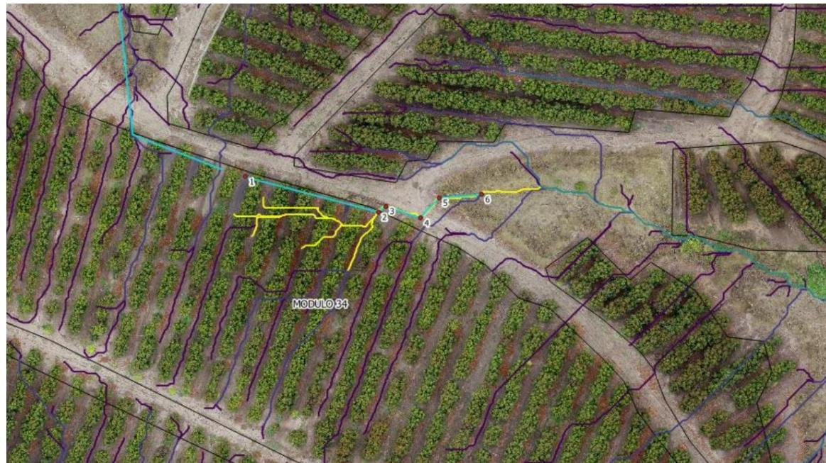
Estimación de curvas de nivel y análisis de terreno (simulación drenajes, pendientes, etc.).
